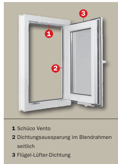
Schematische Darstellung der Luftströmungswege bei Einsatz des Schüco Vento Lüftungssystems im Kunststofffenster.
